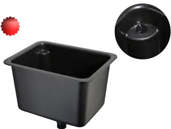
WJH0357AY PP 中水槽 PP Mid-sized Sink 内尺寸: 390*290*260 外尺寸: 440*340*270
